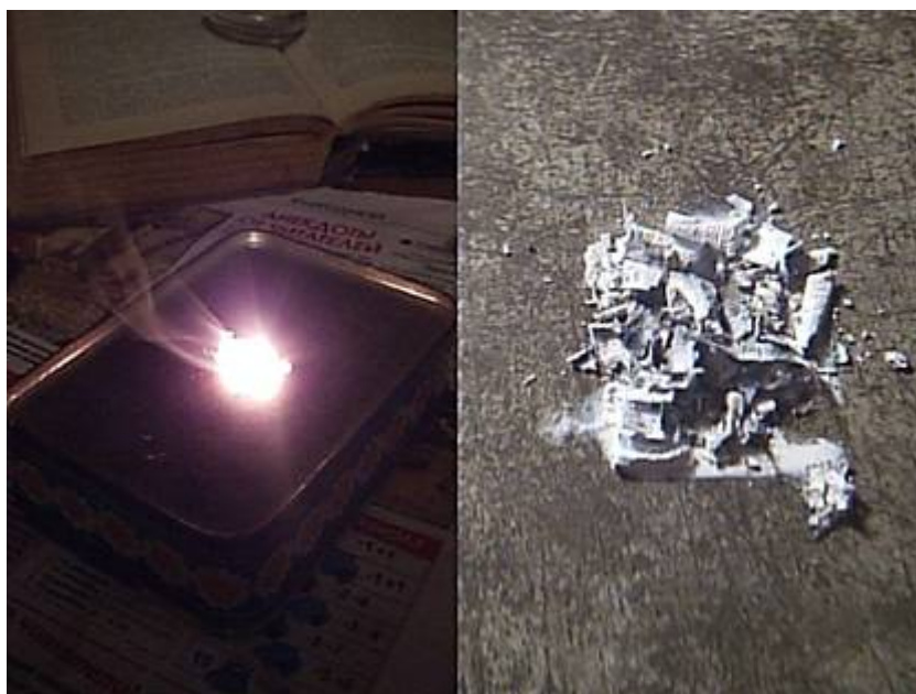
Горение магния на воздухе и \text{MgO} , который образуется в результате реакции
